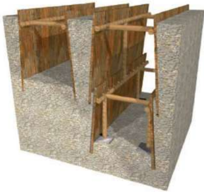
Figura 12 - Metodo di "taglio e spinta verso il basso" di sistemi con bordi di taglio
